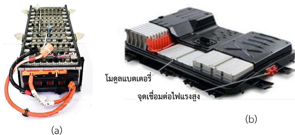
รูปที่ 1.15 แบตเตอรี่ยานยนต์ไฟฟ้าชนิด HEV (a) และ BEV (b)
