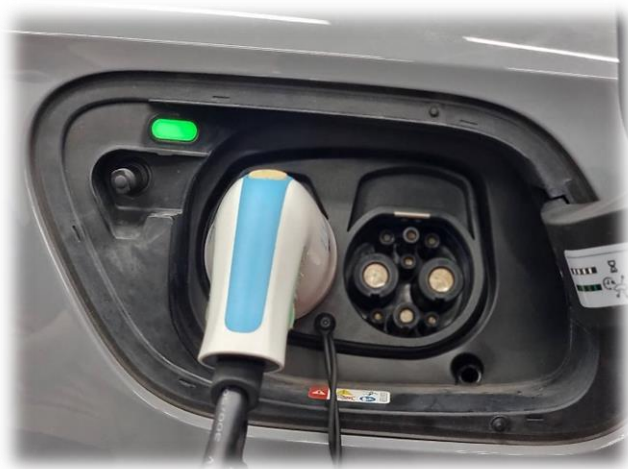
รูปที่ 1.19 พอร์ทชาร์จสำหรับประจุอัดไฟแบตเตอรี่ของยานยนต์ไฟฟ้า รองรับการประจุไฟแบบช้า (AC Charge) และการประจุแบบเร็ว (DC Charge)
