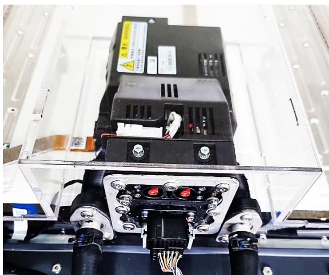
รูปที่ 4.2 อุปกรณ์ BMS ที่ติดตั้งกับแพ็คแบตเตอรี่ของรถยนต์ไฟฟ้า BYD
