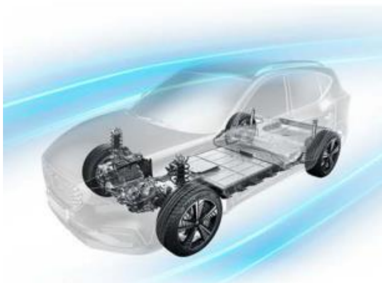
รูปที่ 3.21 ตำแหน่งติดตั้งแบตเตอรี่สำหรับยานยนต์ไฟฟ้า MG ZS EV
