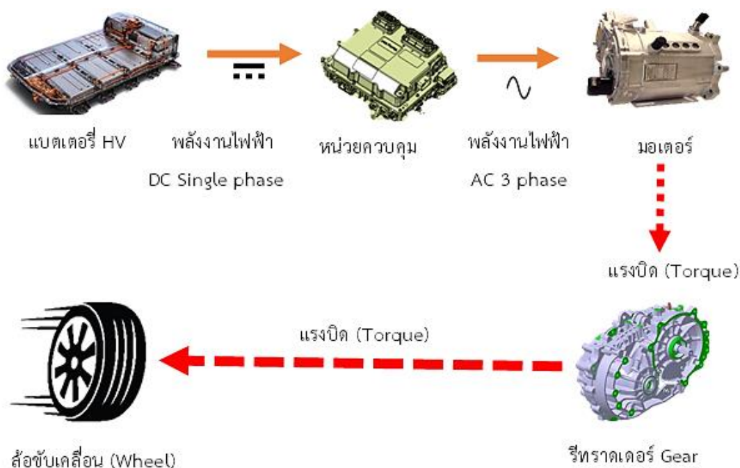
รูปที่ 1.13 แสดงหลักวิธีการทำงานของรถยนต์ไฟฟ้า
