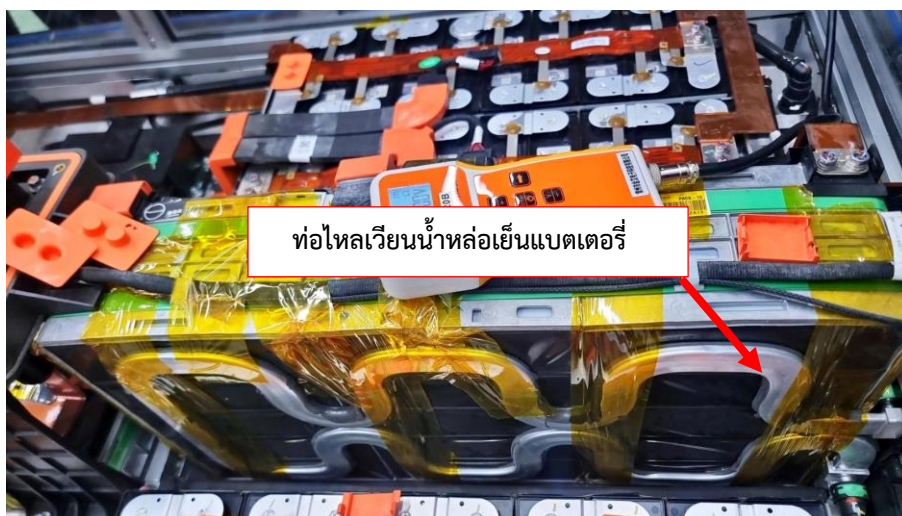
รูปที่ 4.33 การขุดท่อน้ำหล่อเย็นไปตามส่วนต่าง ๆ ของแบตเตอรี่เพื่อระบายความร้อน
