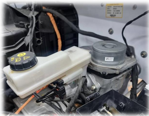
รูปที่ 1.20 ถังบรรจุน้ำมันเบรกและระบบเบรกกำลัง (Power Brake) ของยานยนต์ไฟฟ้า
