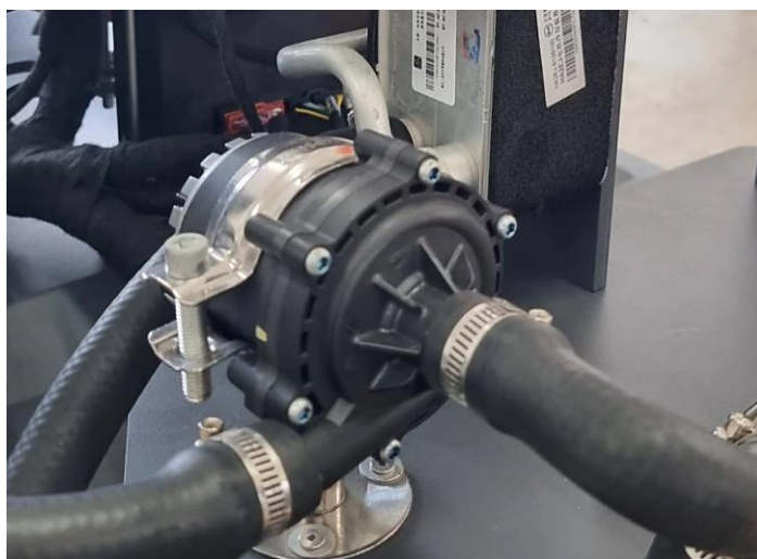
รูปที่ 4.35 ปั๊มไฟฟ้าน้ำยาทำความเย็นระบบระบายความร้อนของแบตเตอรี่
