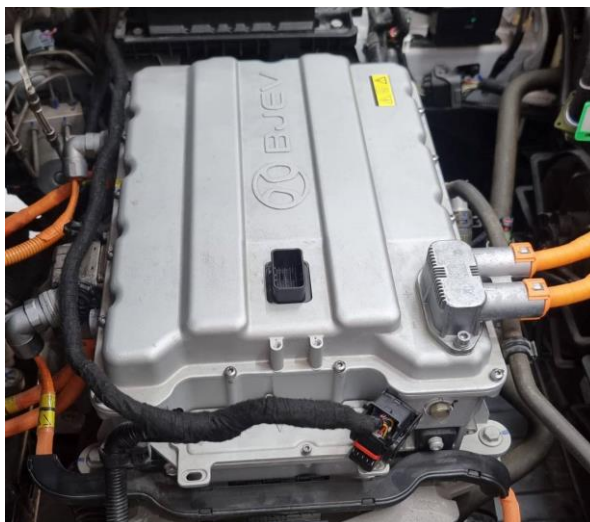
รูปที่ 1.18 คอนโทรลเลอร์ (Controller) ยานยนต์ไฟฟ้าที่รวมอยู่กับชุดออนบอร์ดชาร์จ (OBC)
