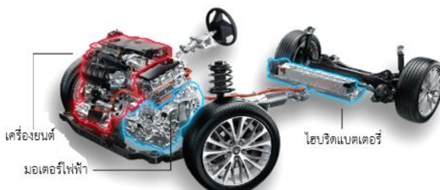
รูปที่ 1.9 ลักษณะโครงสร้างยานยนต์ไฟฟ้า Full Hybrid (FHEV)
