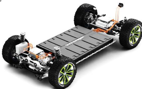
รูปที่ 1.11 ลักษณะโครงสร้างยานยนต์ไฟฟ้าพลังงานแบตเตอรี่ (Battery Electric Vehicle: BEV)
